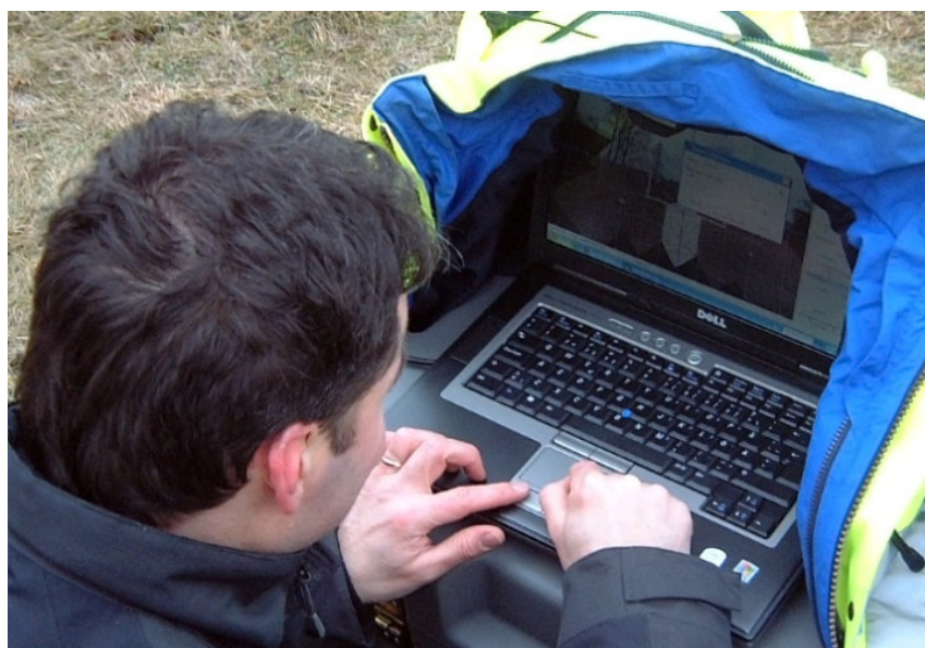
Figur 3.8. Laserskannern styrs från laptop med Cyclone 5.8.
