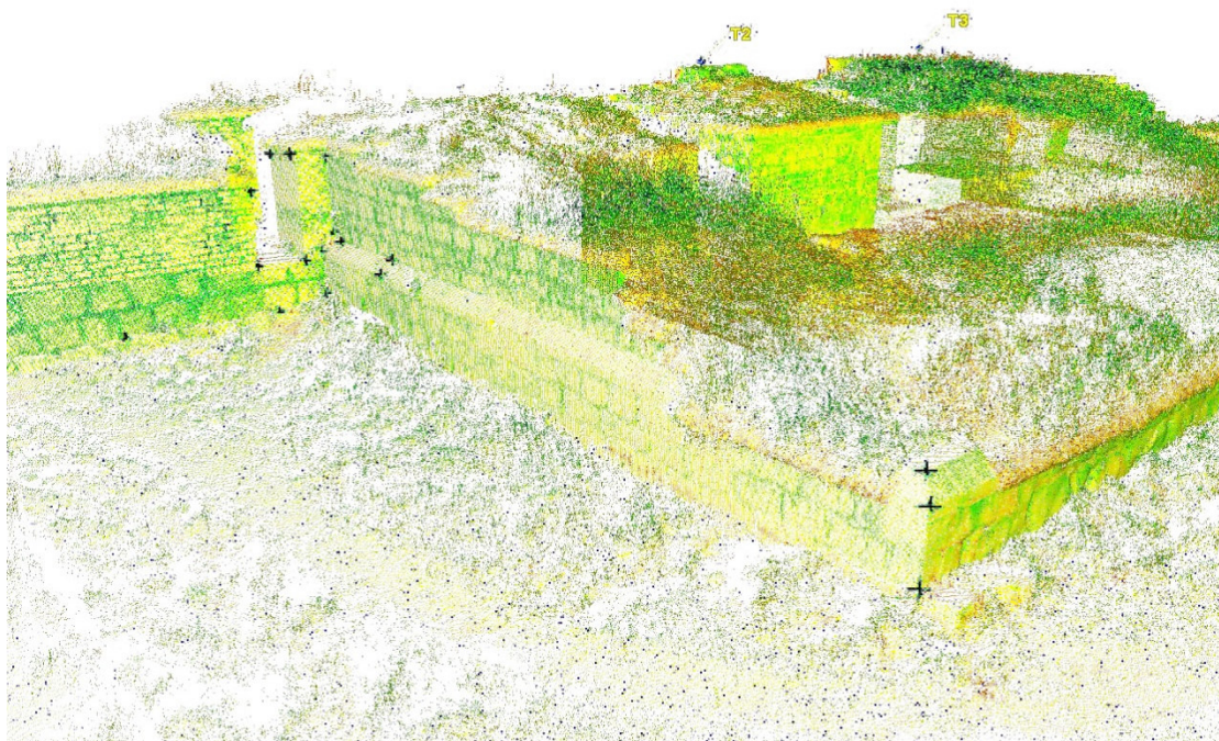
Figur 4.5. Vertexpunkter strategiskt placerade i punktmolnet. Detta för att ge information om ruinens geometri.
